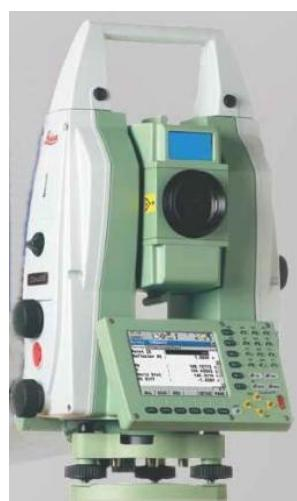
вертикальные углы  $v$  и наклонные расстояния  $S$  до отражателя, установленного на поверхности обмеряемого объекта. По результатам измерений управляющей программой вычисляются пространственное положение ( $X_p$ ,  $Y_p$ ,  $Z_p$ ) определяемых точек в системе координат прибора. Затем координаты всех точек перевычисляют в прямоугольную систему координат объекта.
