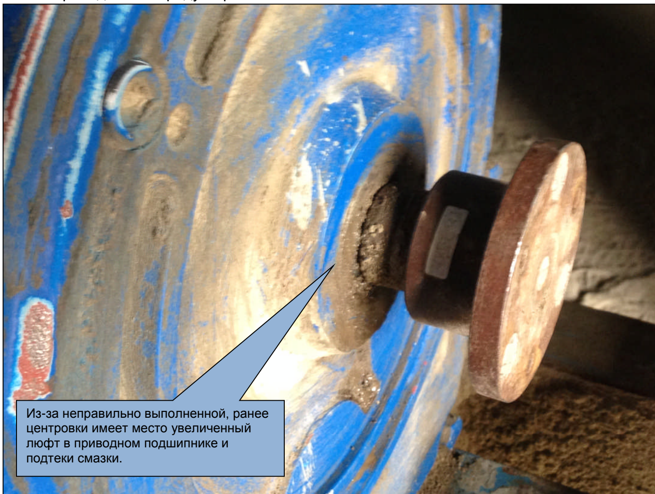
Рис 2. Приводной вал редуктора.
